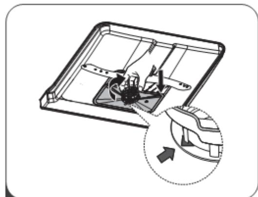
4 Соберите фильтры в порядке, обратном разборке, замените вкладыш фильтра и поверните по часовой стрелке до стрелки закрытия.
