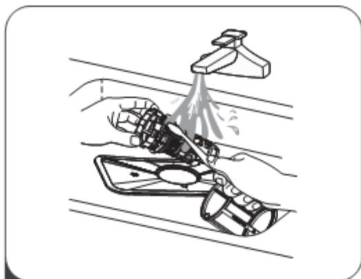
3 Крупные остатки пищи можно очистить, промыв фильтр под проточной водой. Для более тщательной очистки используйте мягкую чистящую щетку.
