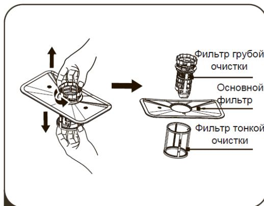
2 Фильтр тонкой очистки можно снять с нижней части фильтровального узла. Фильтр грубой очистки можно отсоединить от основного фильтра, осторожно прижав выступы сверху и вытянув его.
