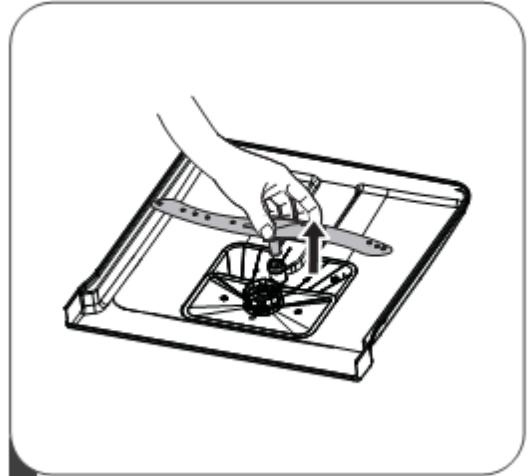
1 Чтобы снять верхний разбрзгиватель, удерживайте гайку в центре неподвижно, поверните разбрзгиватель против часовой стрелки и снимите его.
