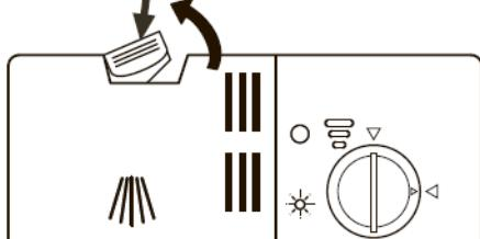
1 Нажмите на защелку на дозаторе моющего средства, чтобы открыть крышку.
