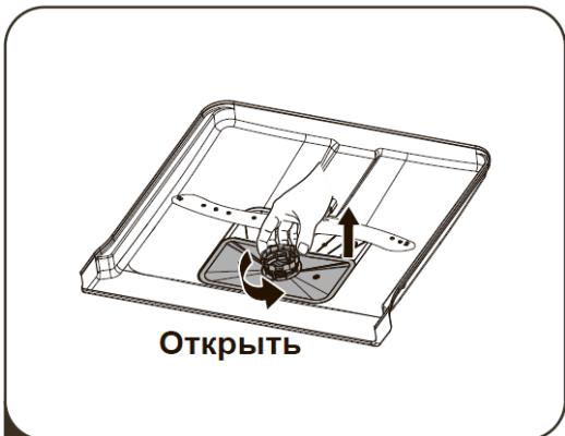
1 Удерживая фильтр грубой очистки, поверните его против часовой стрелки для разблокировки. Поднимите фильтр вверх и извлеките из посудомоечной машины.
