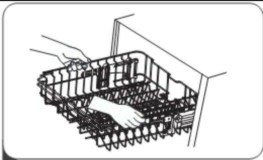
1 Чтобы поднять верхнюю корзину, просто поднимите верхнюю корзину по центру с каждой стороны, пока корзина не зафиксируется в верхнем положении. Нет необходимости поднимать ручку регулятора.
