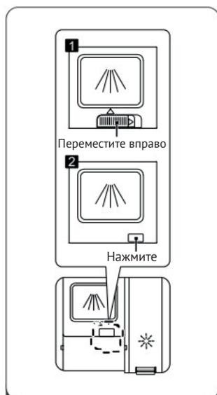
1 Выберите способ открытия отсека в зависимости от модели вашей посудомоечной машины.
