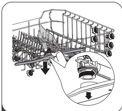
1 Чтобы снять верхнее распылительное коромысло: удерживая неподвижно расположенную в центре гайку, поверните коромысло против часовой стрелки и освободите его.
