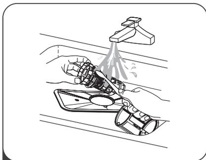
3 Крупные остатки пищи могут быть удалены путем промывки фильтра под проточной водой. Для более тщательной очистки используйте мягкую щетку.
