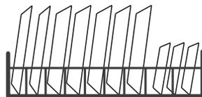
Диаметр тарелок, размещаемых перед дозатором моющего средства, не должен превышать 19 см, иначе может быть затруднено его открытие.
