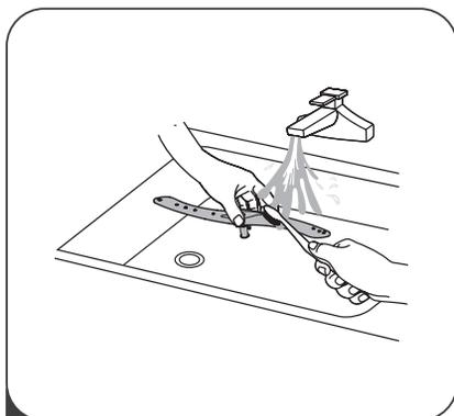
3 Промойте коромысла в теплой мыльной воде, для прочистки сопел используйте щетку с мягкой щетиной. Затем тщательно ополосните их и установите на место.
