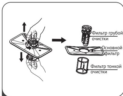
2 Теперь из нижней части узла фильтрации может быть извлечен фильтр тонкой очистки.
