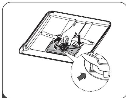
4 Сборка фильтра осуществляется в обратном порядке, вставьте на место узел фильтрации и поверните его по часовой стрелке для закрытия (в соответствии со стрелкой).
