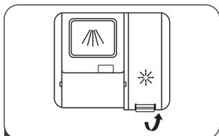
1 Снимите крышку с бачка для ополаскивателя, подняв ручку вверх.
