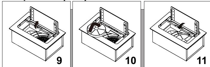
В режиме рециркуляции воздух возвращается обратно на кухню через отверстие в вытяжке. Этот метод рекомендуется, если вы не используете варочную панель интенсивно. Для рециркуляции воздуха необходимо использовать угольные фильтры для удаления запахов. Чтобы обеспечить наилучшую производительность вытяжки, угольный фильтр следует заменять каждые 3-6 месяцев в зависимости от интенсивности использования.
