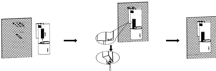
1. Прикрепите подвесную панель к стене с помощью соответствующих винтов, закрепите крепление на стене.
