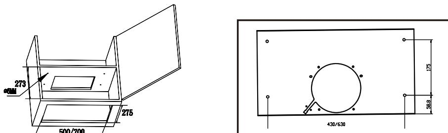
Расположение монтажных отверстий верхней панели шкафа
