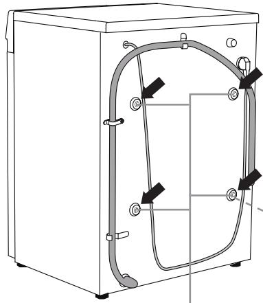
В некоторых моделях необходимо также снять расположенный здесь держатель для шнура электропитания.
