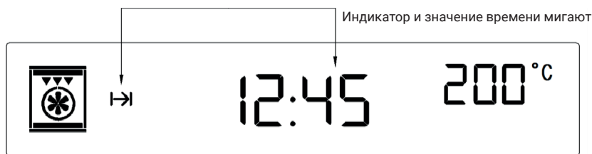
Рисунок 6. Индикация на дисплее во время настройки приготовления с отложенным стартом
